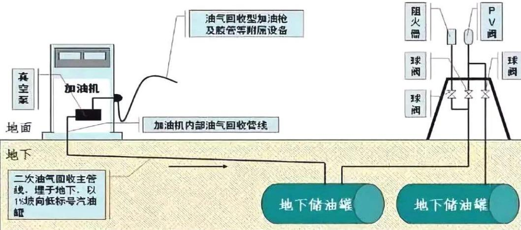
图 3-2 加油油气回收系统图
