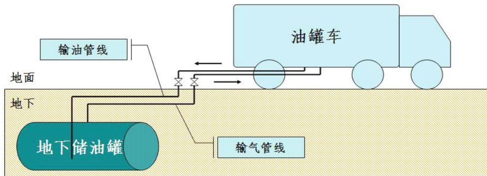
图 3-1 卸油油气回收系统图
