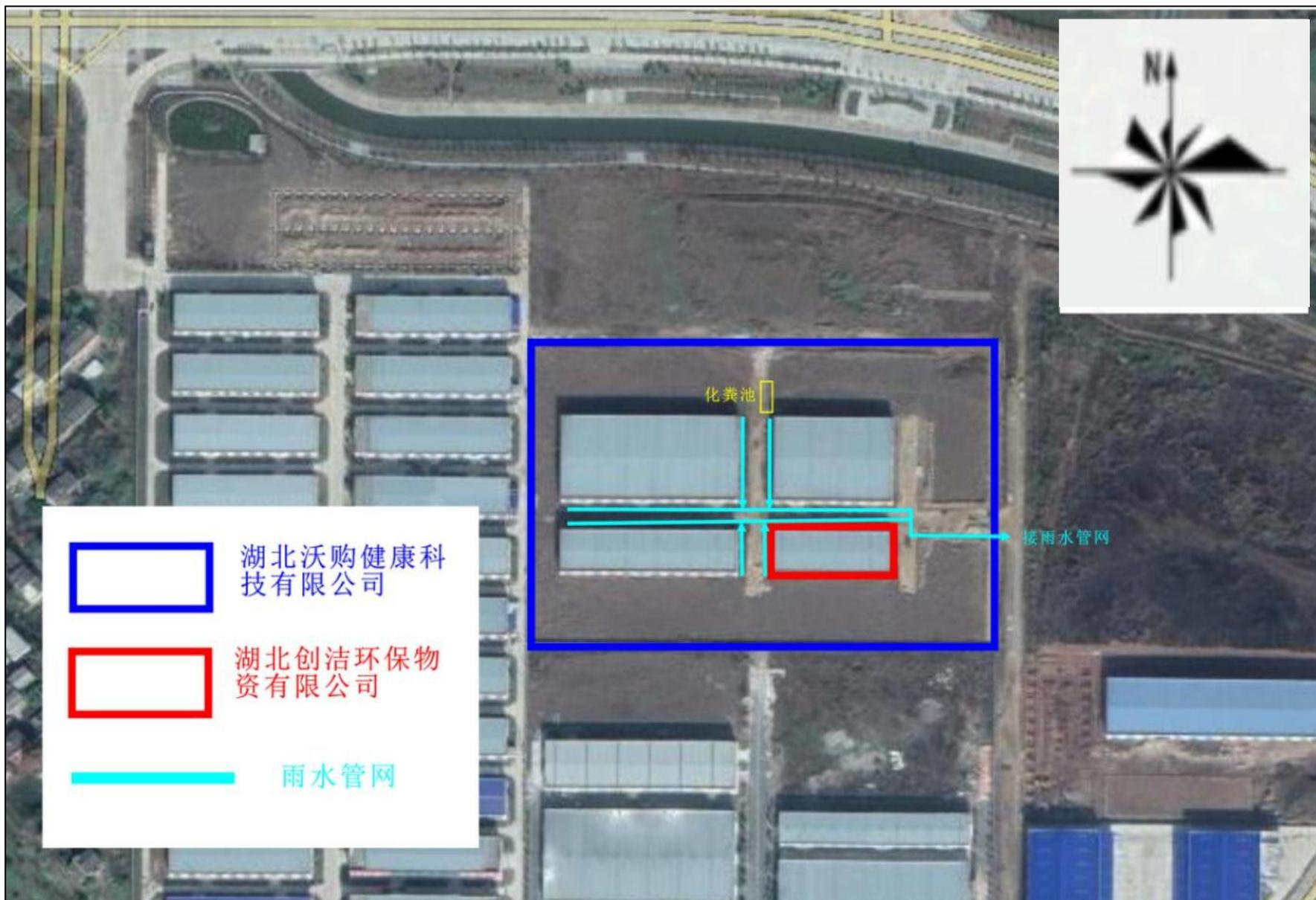
附图 5 项目雨污管网图
